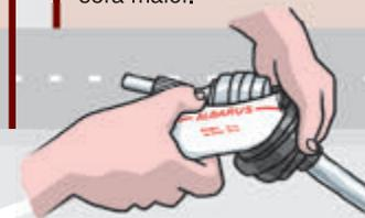
Se o veículo vibrar ou trepidar durante as acelerações, ele pode estar com a homocinética deslizante travada ou com a junta fixa gasta ou danificada.
