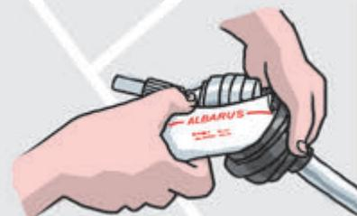
Para prolongar a vida de uma junta homocinética é importante ler atentamente as instruções de manutenção, usar somente graxa especificada e nunca tentar desmontar e montar de novo uma junta contaminada por sujeira ou umidade. Dessa maneira, elas transmitirão torque por milhares e milhares de quilômetros, mesmo que expostas a altas temperaturas e choques mecânicos, como costuma acontecer.
